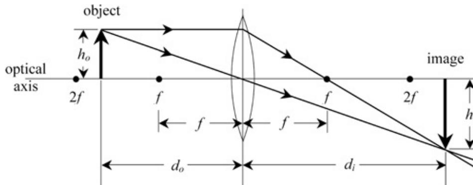
**Figure 16.8. Convex lens**
